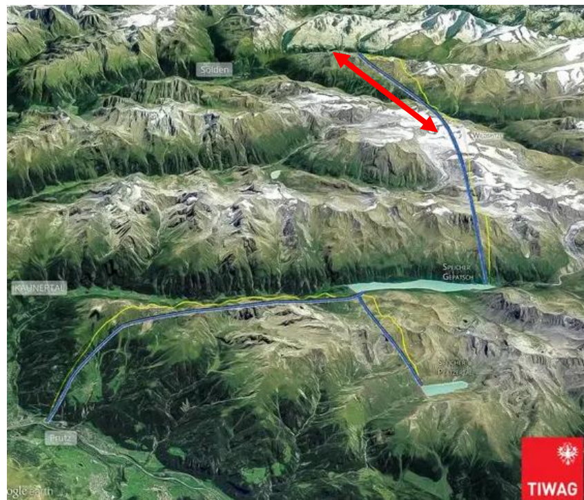
Abbildung 25: Planausschnitt des geplanten Überleitungsstollenauch – ergänzende Markierung des Abschnittes im Einzugsgebiet der Ötztaler Ache (TIWAG Homepage)
